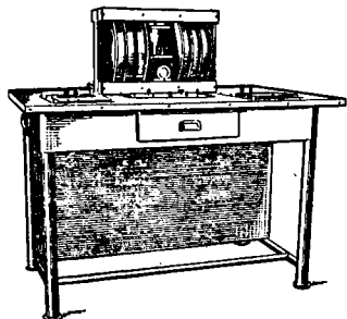
Рис. 39. Внешний вид аналогового коэрцитиметра с полностью замкнутой магнитной системой.
